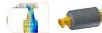
Evaluación en Terreno y Diseño de Poleas Bajo Calculo de Elementos Finitos.
